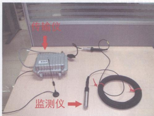
图2 自动化监测设备连接示意图
